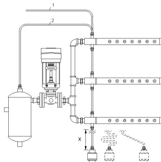
Длина трубы "Х" должна составлять не менее 1 метра, чтобы обеспечить эффективную работу капсулального конденсатоотводчика. При этом возможны разные варианты установки, в том числе и при дефиците места. Важно обеспечить оптимальное, вертикальное монтажное положение капсулального конденсатоотводчика на конце. Значение давления в линии для конденсата не должно превышать половины от значения давления пара в нагревательной линии. Трубопровод всегда должен идти с уклоном!
