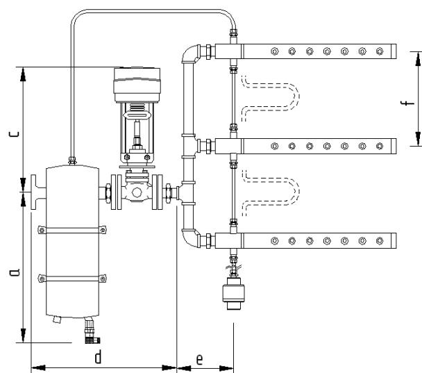
\* Напорная паровая система, вариант А (нержавеющая сталь)
