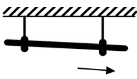
Паропровод всегда следует прокладывать с уклоном. Точки крепления должны располагаться на необходимом расстоянии. Используйте соответствующие крепёжные материалы. Крепления труб должны допускать продольное движение линии. На длинных линиях следует предусмотреть компенсацию расширения, чтобы исключить слишком значительное расширение.
