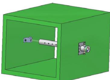
Расстояние между парораздатчиками и верхней стенкой либо дном канала должно составлять не менее 200 мм.
