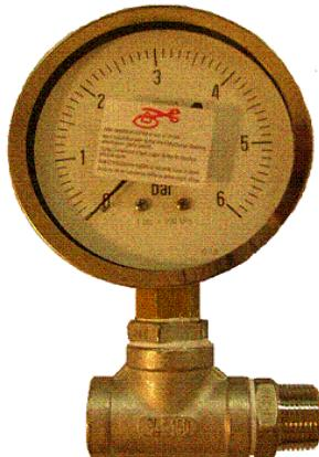
Установка манометра на паровой установке позволяет оперативно фиксировать снижение или колебания давления.
