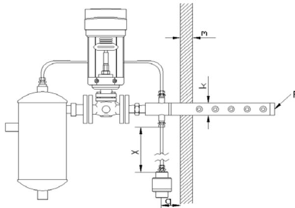
Чтобы пар не конденсировался на внутренней стенке канала, парораздатчики следует монтировать с учётом следующих размеров:
